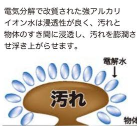
電気分解で改質された強アルカリイオン水は浸透性が良く、汚れと物体のすき間に浸透し、汚れを膨潤させ浮き上がらせます。
