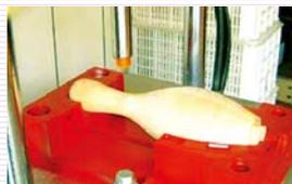
水分率10%以下の北米産原木(硬質メイプル材)を組み合わせたピンの木芯を、インジェクション加工する前にマシンに固定し、ネックの真上より450PSI(平方インチに450ポンド≒204kg)の瞬間衝撃(0.5秒)を実施します。瞬間衝撃を受けたあと、ネックにひびや折れが見られないものを合格品とします。
