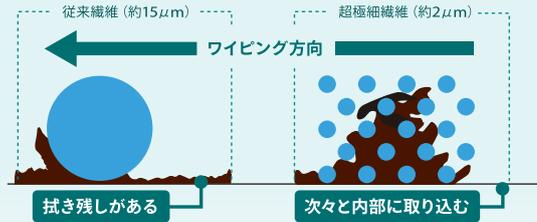
従来繊維では、油膜や粉塵を引き伸ばすだけで、完全に拭き取ることができません。超極細繊維は拭き取り面に密着し、毛細管現象により繊維空隙に汚れを次々と取り込むことができるので(インナートラップ機能)高いワイピング性能を発揮するのです。
